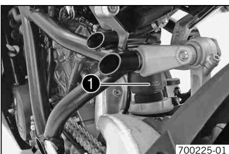
La référence de l'amortisseur ❶ est frappée sur la partie supérieure de l'amortisseur, au-dessus de la bague de réglage, vers l'arrière.
