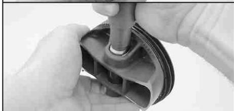
Guide de circlip d'axe de piston (75029035000) (☛ p. 208)
